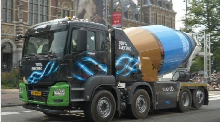
Minder CO 2 emissie in de bouw Elektrische Betonmixer van Kijlstra
